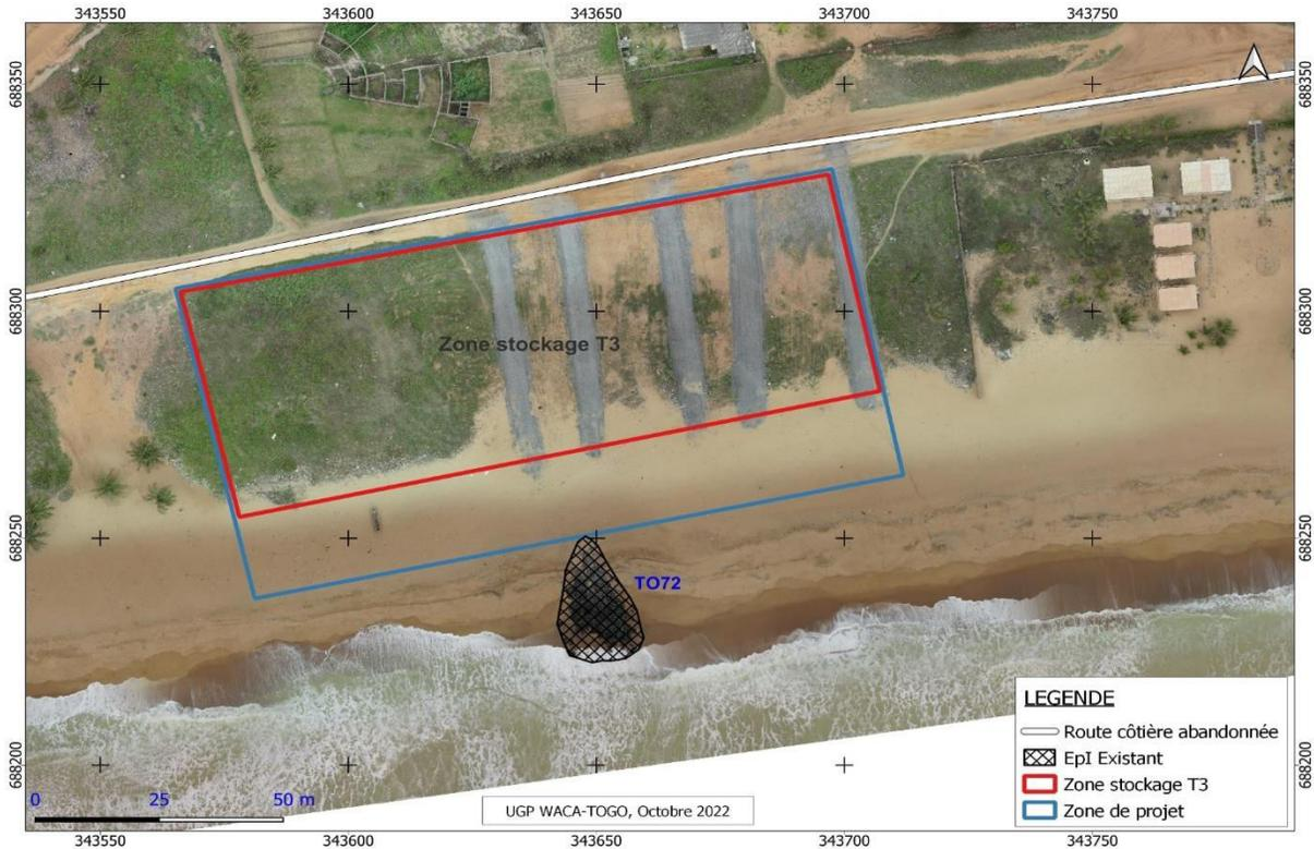
**Figure 9:** épi TO 72 et zone de stockage T3 (couvert par l'annexe 1 : 1er rapport de screening pour les zones de mobilisation de rochers et d'installation de chantiers) *Source : WACA ResIP Togo, octobre 2022*
