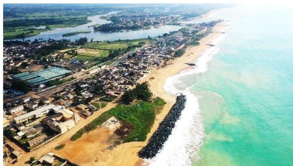
**Photo 27 :** Protection longitudinale (Brise-lames) existant à Aného devant être prolongé de 200 m
