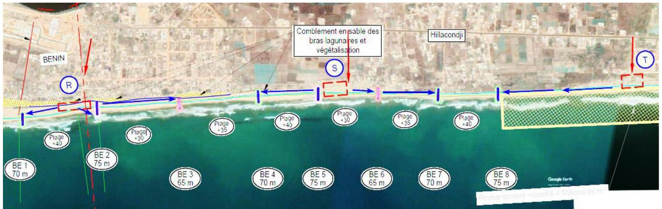
**Figure 74:** Accès et zone de stockage des enrochements prévisionnels au niveau d'Hillacondji et Agoué
