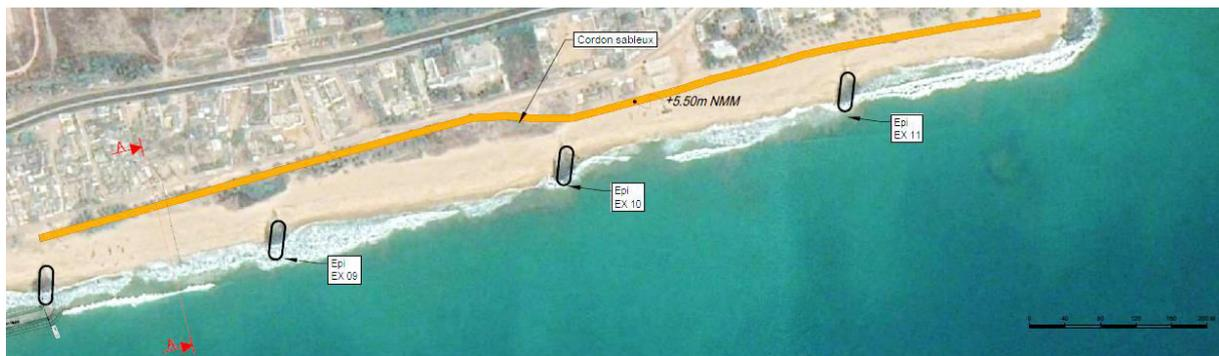
**Figure 71:** Vue en plan de l'implantation du cordon sableux au niveau d'Aného
