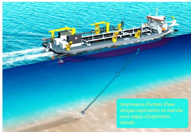
Figure 79: Illustration d'une drague aspiratrice en Marche de Jan de Nul
